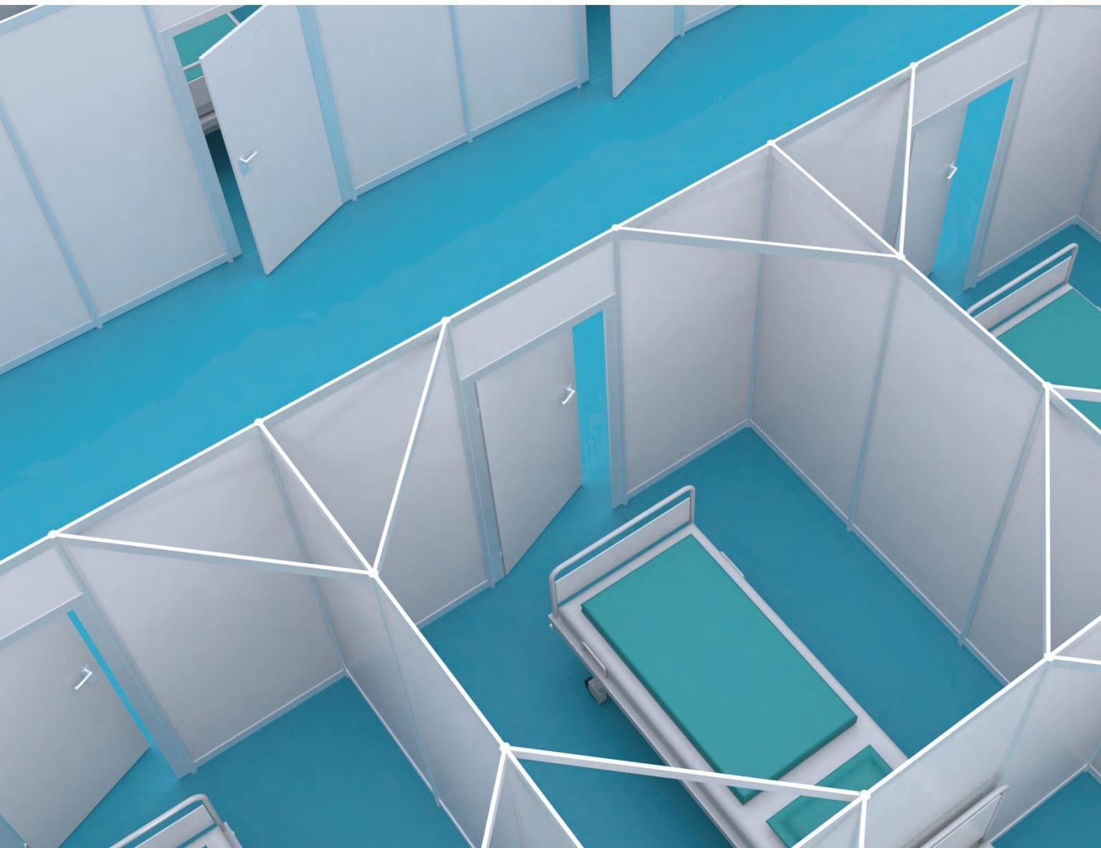
モジュール方式を採用することで簡単に規模を拡大することが出来ます。
