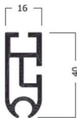
**BEAM EXTRUSION 40mm**
