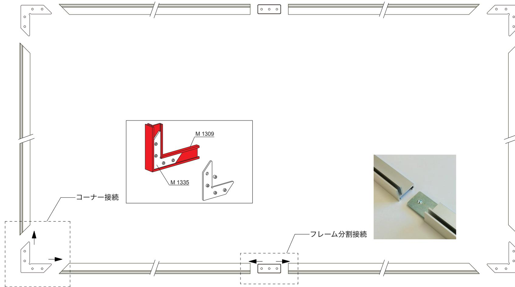
手順①：コーナー金具金具を所定位置の溝に設置
